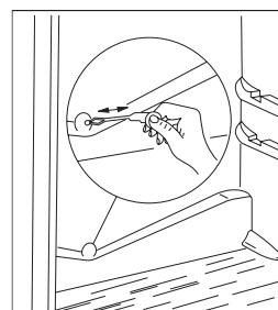
**⚠ Регулярно проверяйте состояние и чистите отверстие для стока талой воды, поскольку если оно окажется перекрытым, скопившаяся оттаявшая вода может проникнуть в изоляционный слой и привести к преждевременному выходу прибора из строя.**
