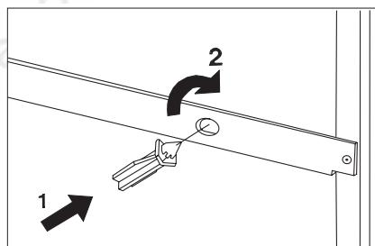
Установите штифты, поставляемые в комплекте принадлежностей. Выполняйте действия согласно рисункам, штифт следует вставить до упора. Для фиксации штифта поверните его на 90° (в оба овальных отверстия на тыльной стороне).
